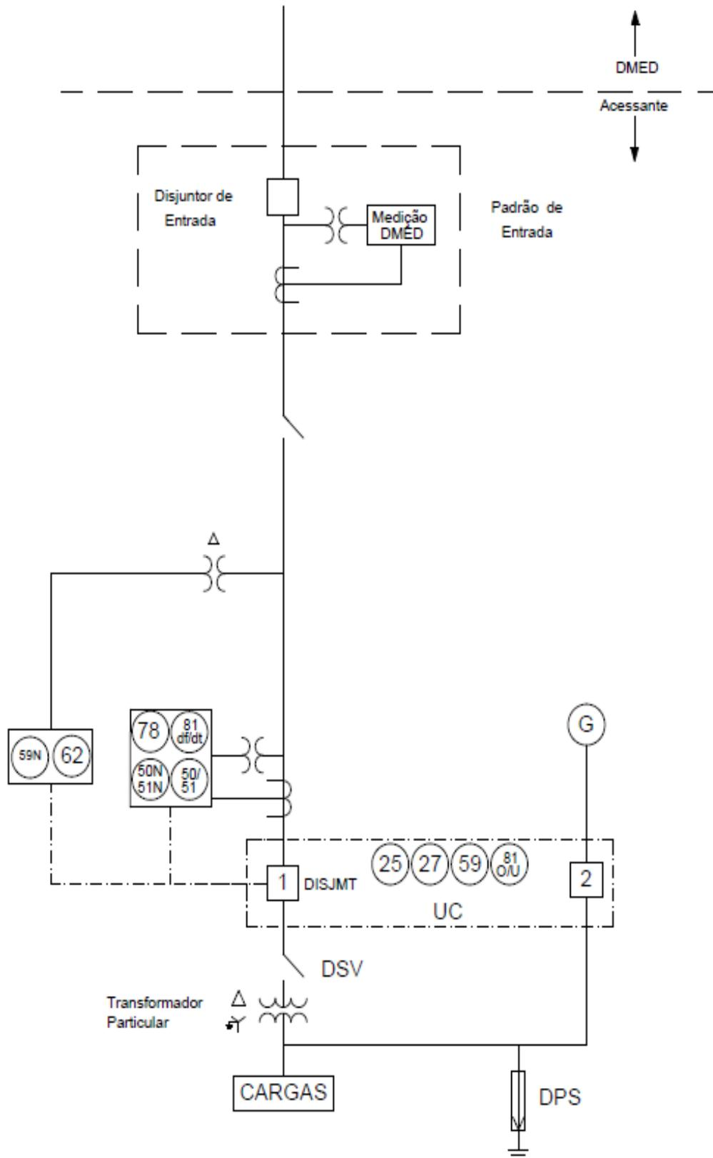
**Desenho 9:** Geração Própria Tipo 4 com Potencia >300 e ≤ 500 kW sem inversor com Transformador Elevador
