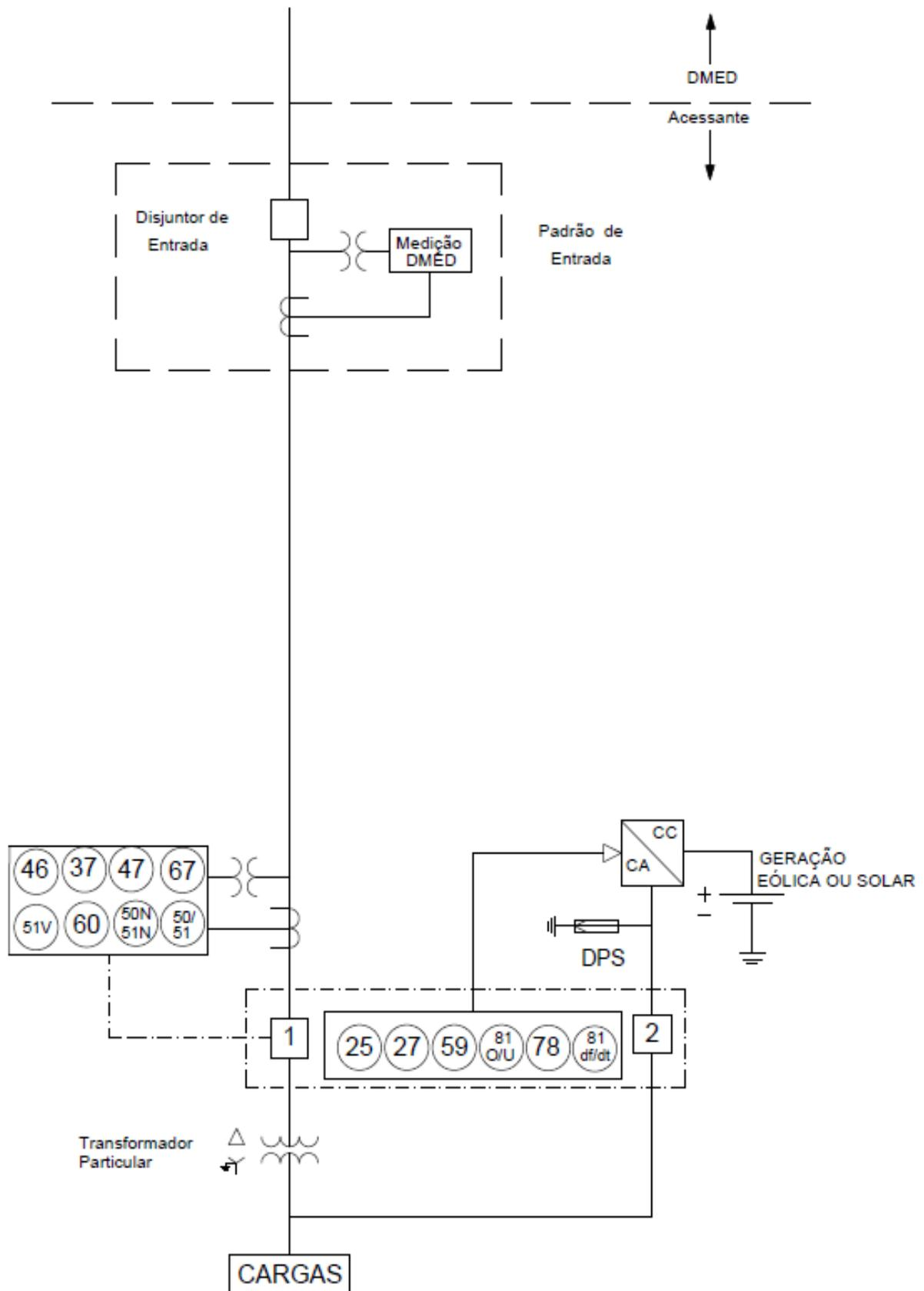
**Desenho 17:** Geração Própria Tipo 4 com Potencia >500 kW com inversor com Transformador Elevador
