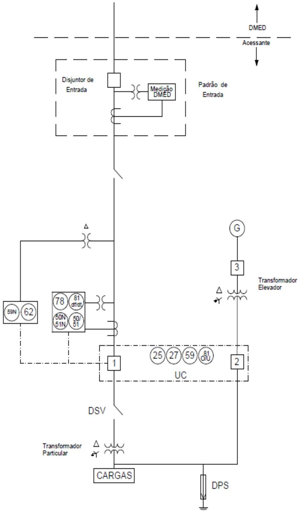
**Desenho 10:** Geração Própria Tipo 4 com Potencia >500 kW sem inversor
