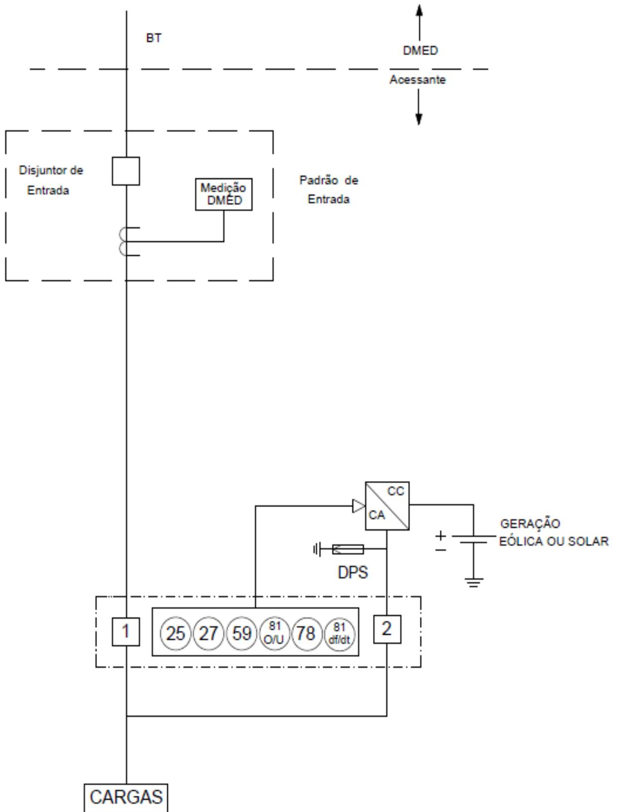
**Desenho 13:** Geração Própria Tipo 4 com Potencia >75 e ≤ 300 kW com inversor
