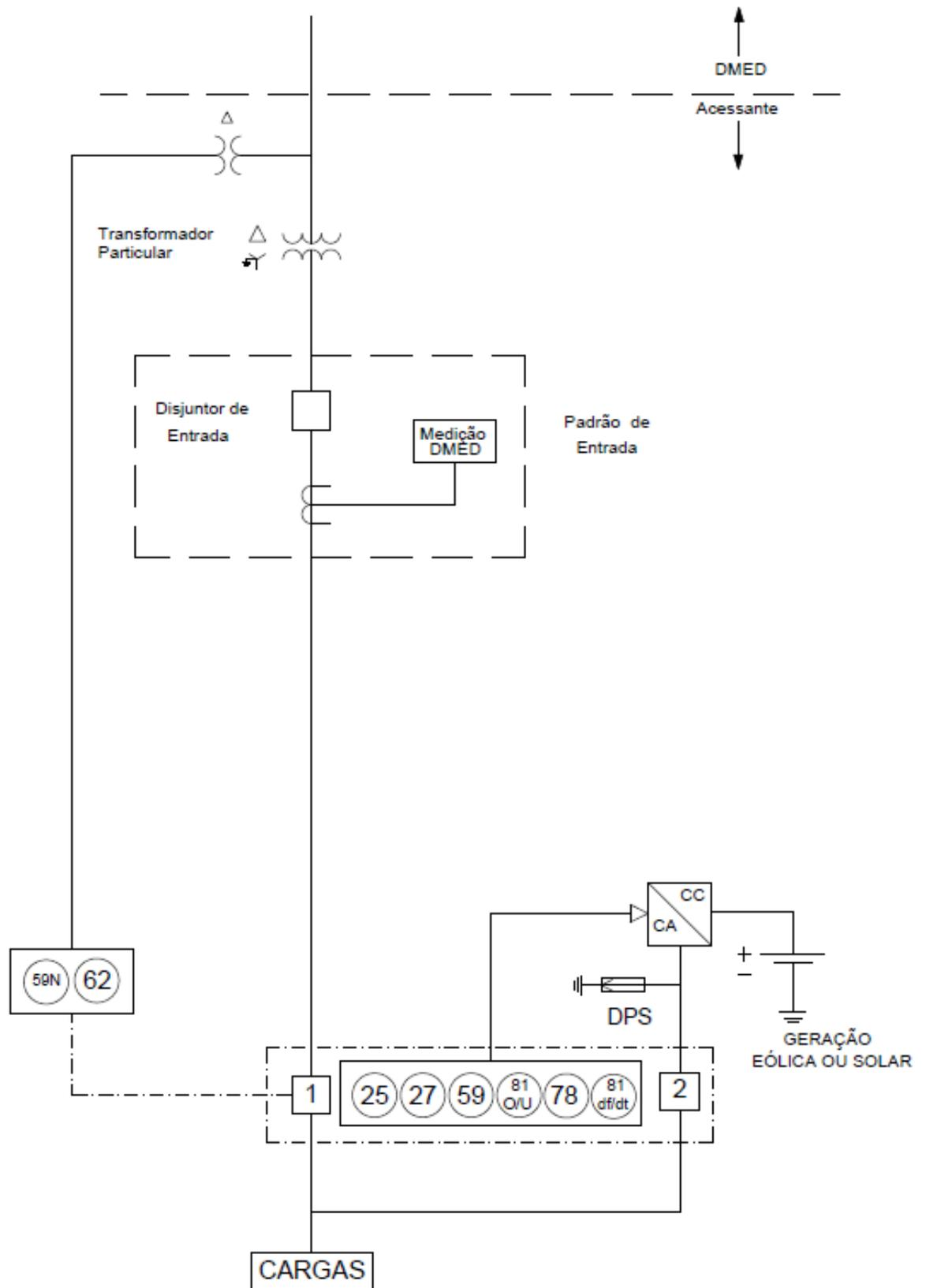
**Desenho 14:** Geração Própria Tipo 4 com Potencia >300 e ≤ 500 kW com inversor
