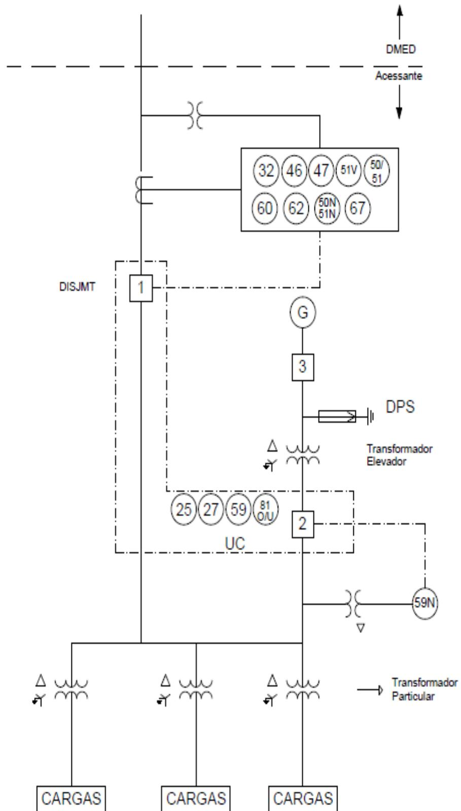
Desenho 6: Geração Própria Tipo 4 com Potência  $\leq 75$  kW sem inversor
