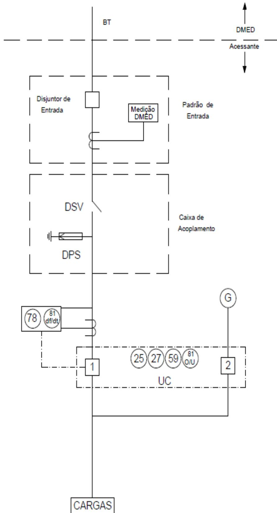
**Desenho 7:** Geração Própria Tipo 4 com Potencia >75 e ≤ 300 kW sem inversor
