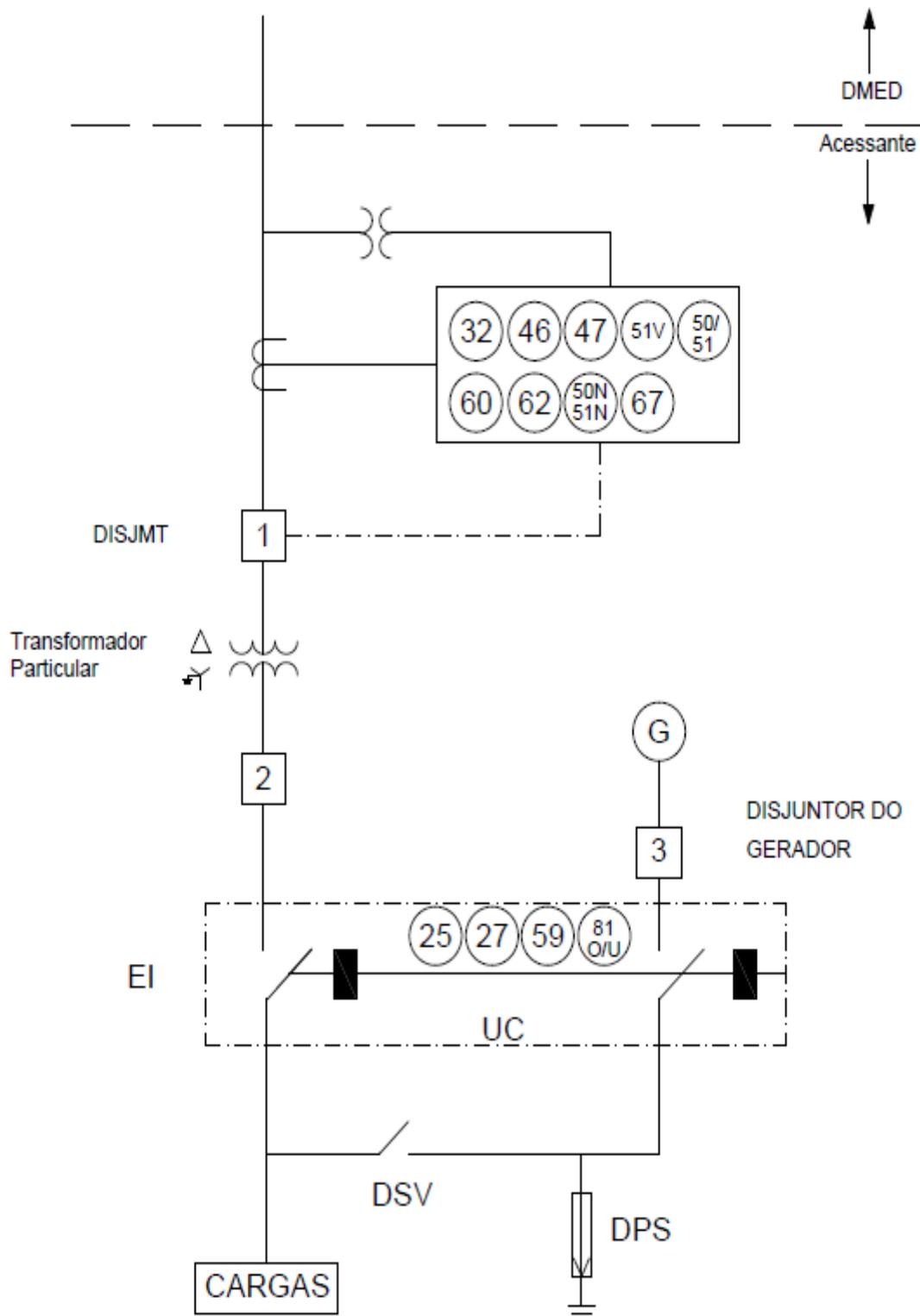
**Desenho 5:** Geração Própria Tipo 2 e 3 com Potencia > 300 kW com Transformador Elevador
