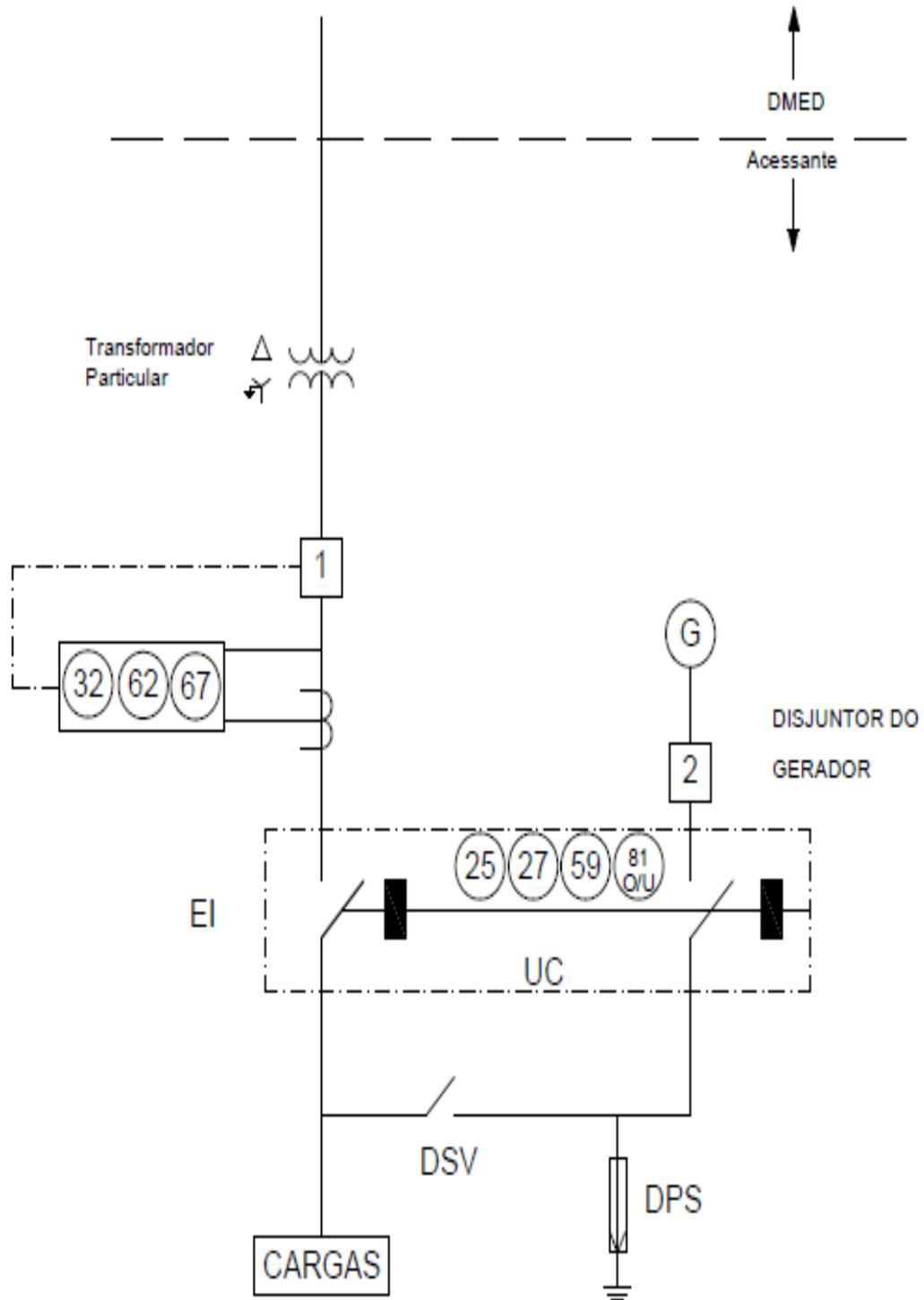
Desenho 4: Geração Própria Tipo 2 e 3 com Potencia > 300 kW
