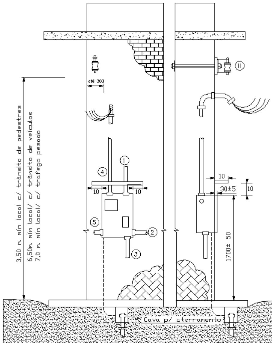
Unifilar da ligação do medidor
