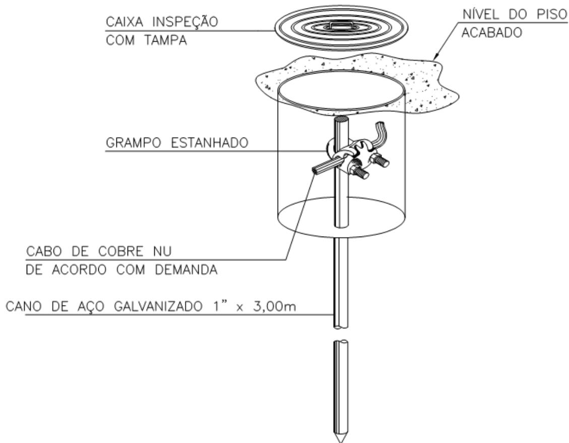
**FIGURA 43 MATERIAIS PADRONIZADOS SISTEMA DE ATERRAMENTO TUBO DE AÇO, GALVANIZADO A FOGO.**
