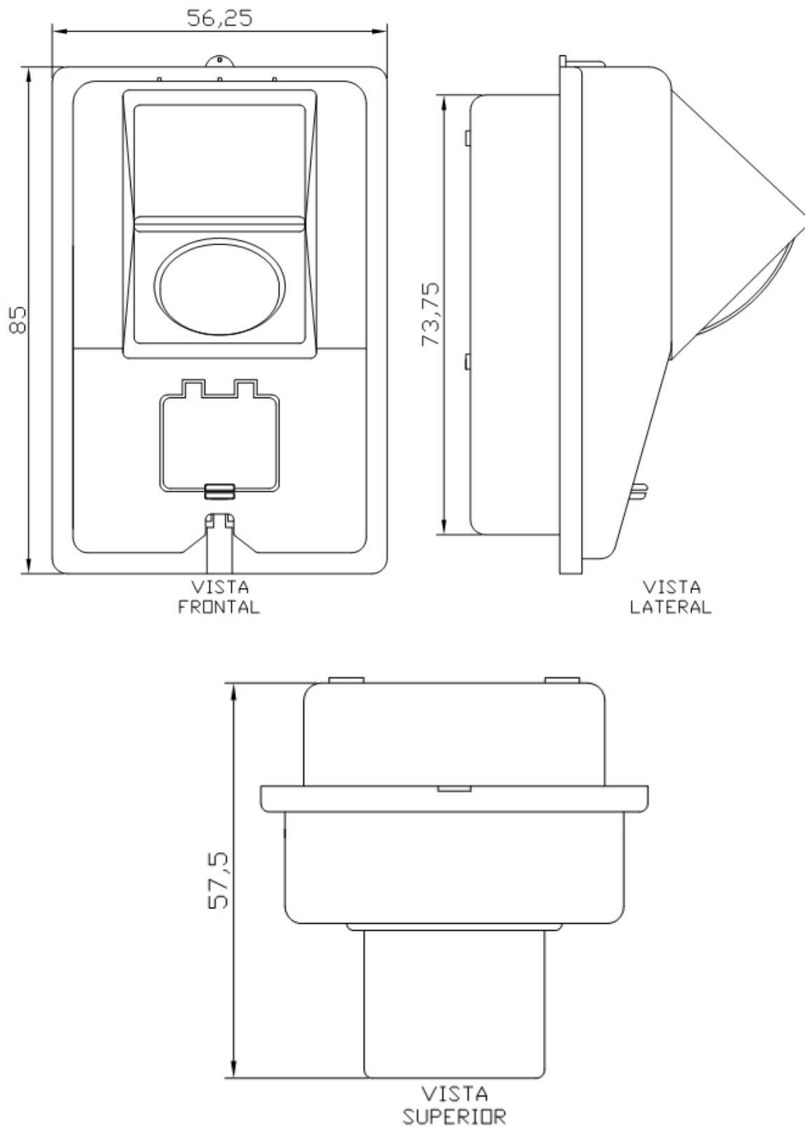
**FIGURA 60 CAIXA POLICARBONATO MONOFÁSICA LEITURA EM POSTE COM DISJUNTOR SEPARADO**
