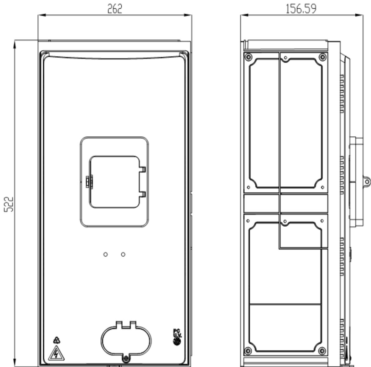
**FIGURA 63 CAIXA DE PASSAGEM EM POLICARBONATO**
