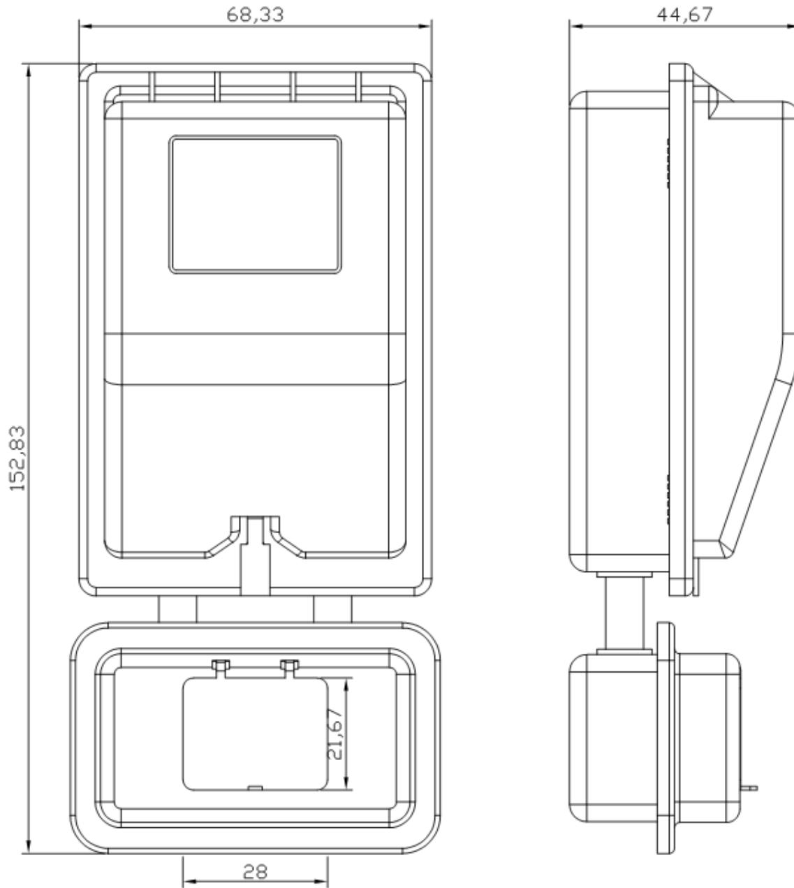
**FIGURA 61 CAIXA POLICARBONATO MONOFASICA OU POLIFÁSICA MONTAGEM EM MURETA**
