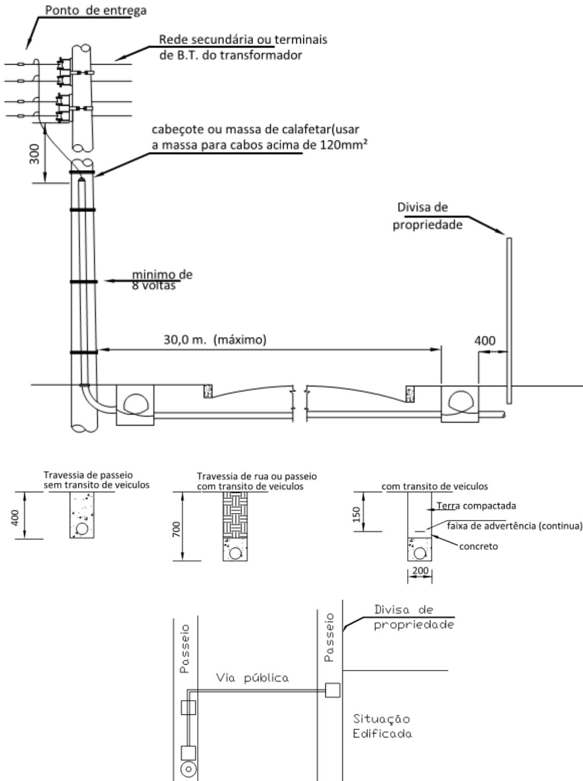
**FIGURA 20 ELEMENTOS E COMPONENTES DA ENTRADA DE SERVIÇO SUBTERRÂNEA EM BAIXA TENSÃO, EDIFICAÇÕES DE USO COLETIVO COM DEMANDA ENTRE 95 ATÉ 300 kVA**
