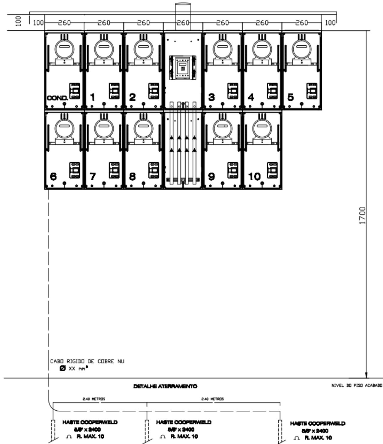
**FIGURA 55 EXEMPLO DE MONTAGEM DE CONJUNTO DE MEDAÇÃO USO DE CAIXAS EM POLICARBONATO COM 1 FILEIRA.**
