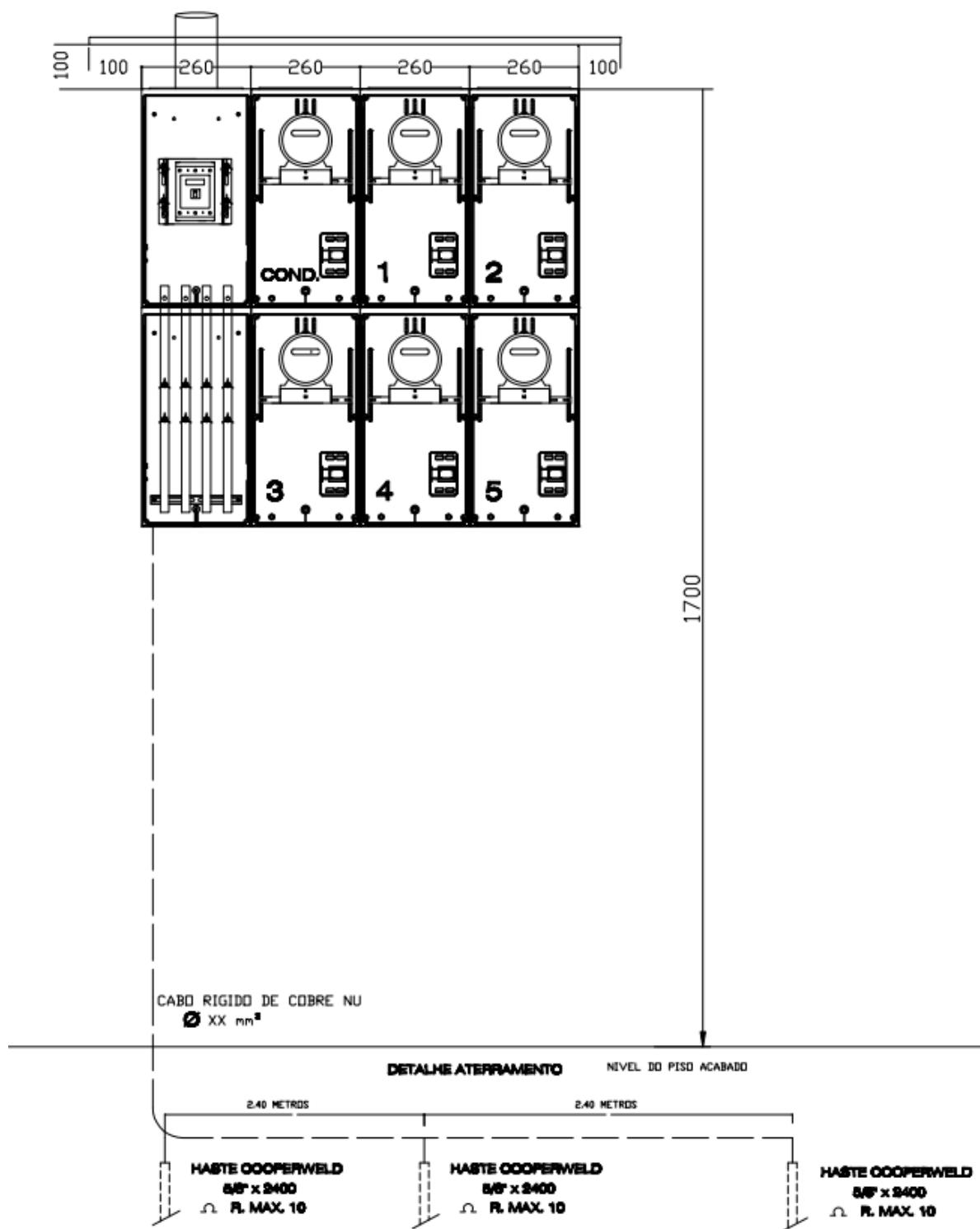
**FIGURA 54 EXEMPLO DE MONTAGEM DE CONJUNTO DE MEDAÇÃO COM USO DE CAIXAS EM POLICARBONATO COM 2 FILEIRAS.**
