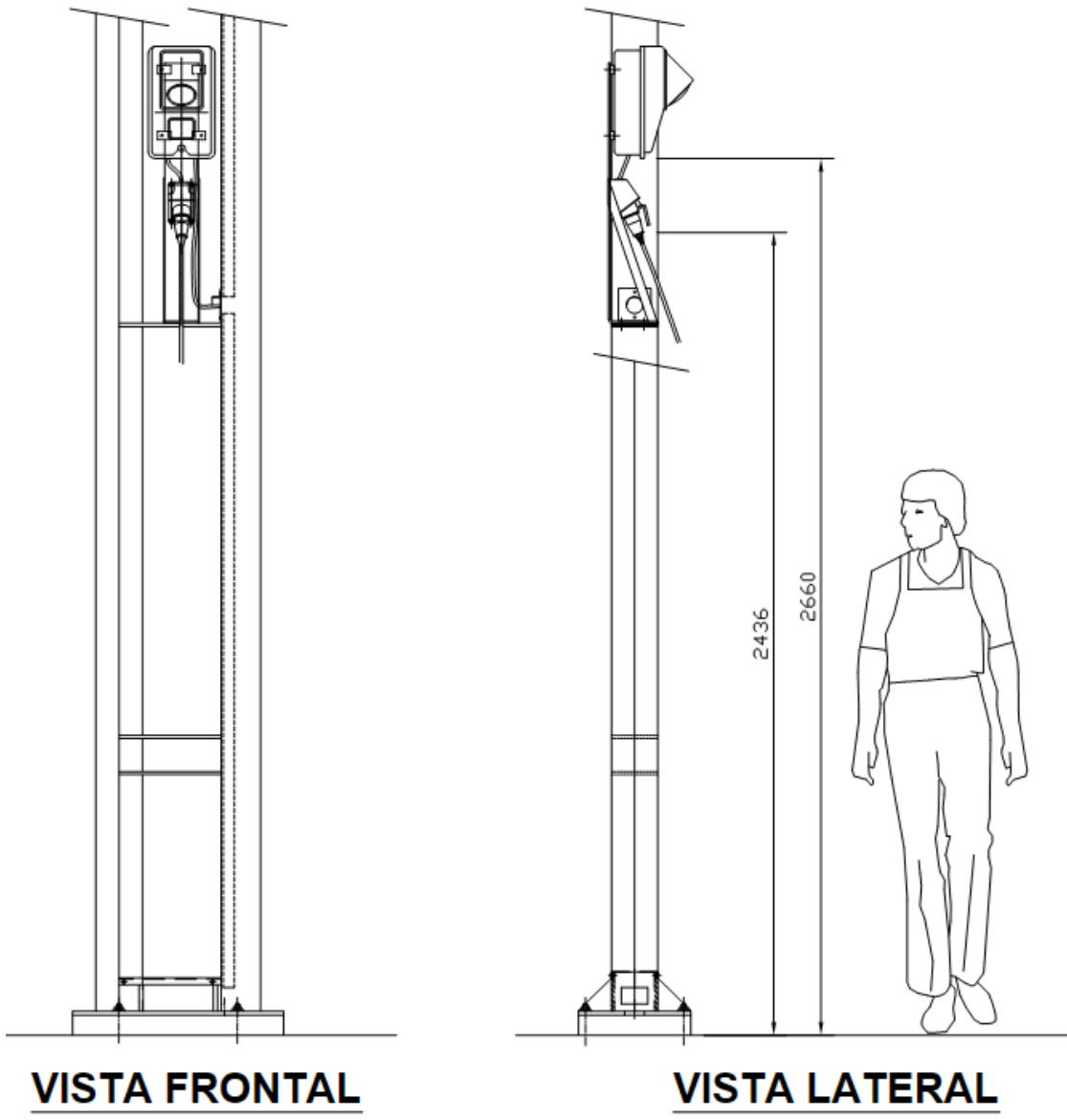
**FIGURA 15 PADRÃO COM RAMAL DE LIGAÇÃO AÉREO LIGAÇÃO A 4 FIOS EM MURO OU MURETA, MEDAÇÃO INDIRETA COM TRANSFORMADOR PARTICULAR DEMANDA SUPERIOR A 75 KVA**
